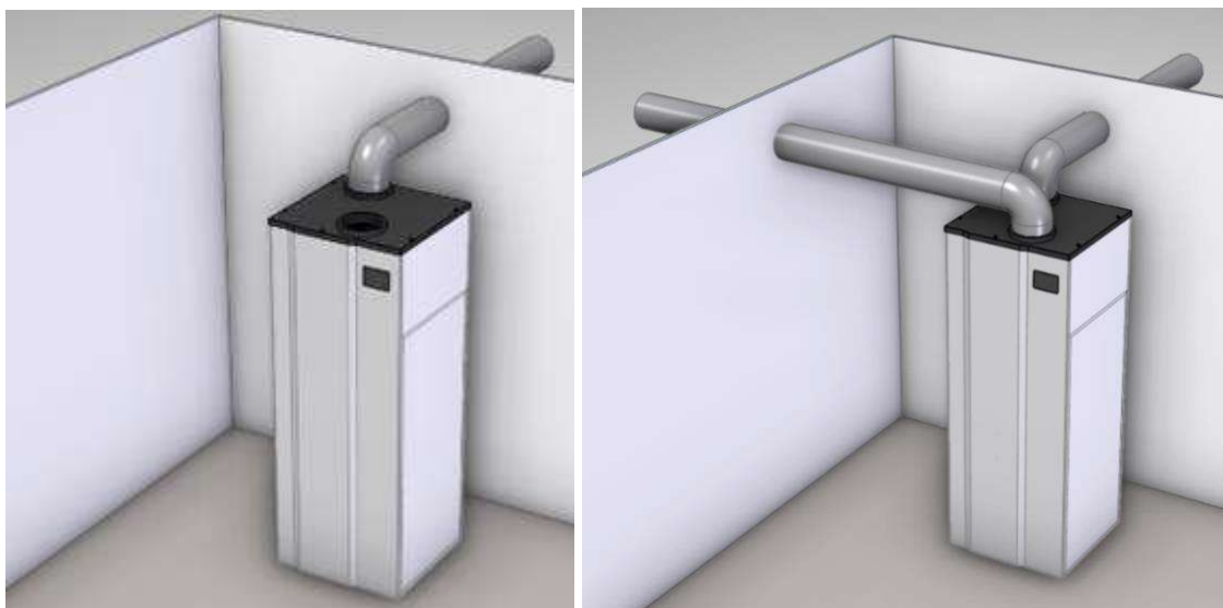
Illustration; Exempel på installation av luftkanaler
